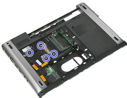
14. Débranchez le câble du ventilateur qui fixe le dissipateur thermique à la carte système.
